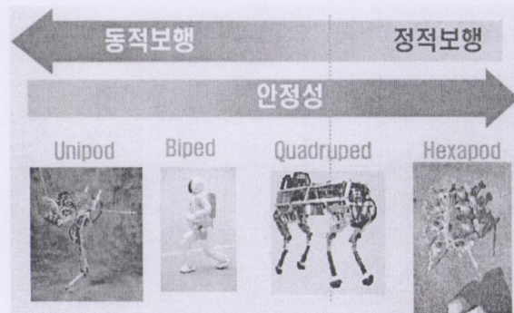
그림 1. 다리 개수에 따른 로봇의 특성[3]
