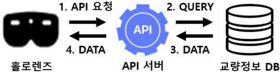
(그림 2) AR을 통한 교량 시설물 안전 점검 시스템 구조도
