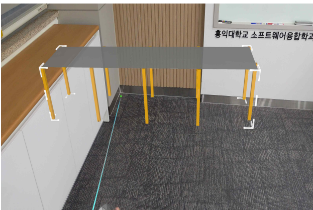
그림 7. 홀로렌즈2에 출력된 BIM 3D 모델
