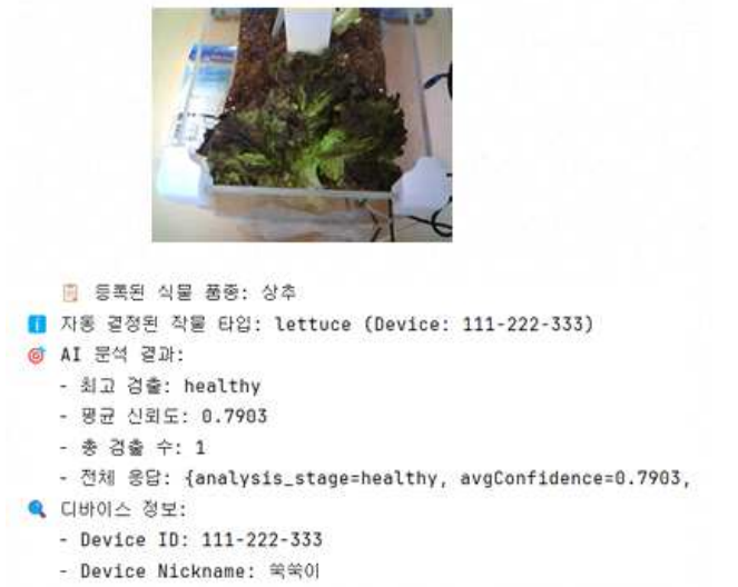
(그림 2) AI 기반 생육 상태 분석 결과 (Healthy 판정 사례) 그림 2는 AI 기반 생육 상태 분석 결과에 대한 Healthy 판정 사례이다. 실험을 통해 본 시스템이 식물의 정상 생육 상태를 판별하고, 계층적 분석 구조를 통해 식물의 성장 상태를 사용자에게 제공함을 확인한다.
